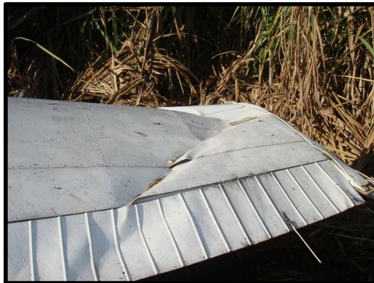
ESTABILIZADOR DERECHO CON GOLPE FOTOGRAFIA No. 10
