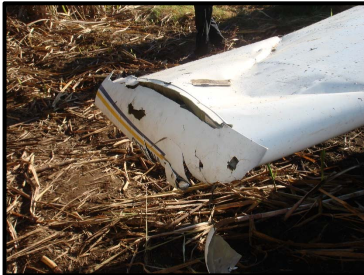
FOTOGRAFIA No. 12 VISTA DE DAÑOS A LAS SIEMBRAS Y EL ALA DERECHA.
