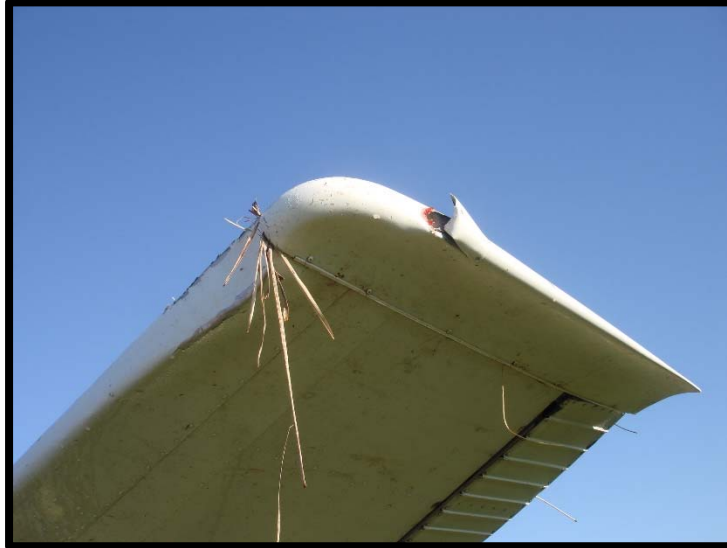
FOTOGRAFIA No. 5 DAÑOS EN EL ALA IZQUIERDA
