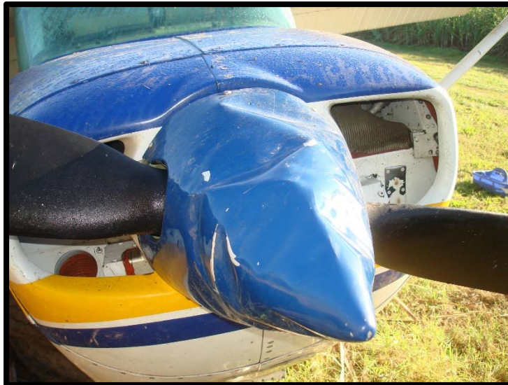
FOTOGRAFIA No. 6 DAÑOS EN LA PARTE FRONTAL DE LA AERONAVE Y MOTOR
