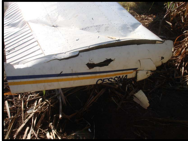
EL ALA DERECHA DAÑADA POR EL GOLPE. FOTOGRAFIA No.9
